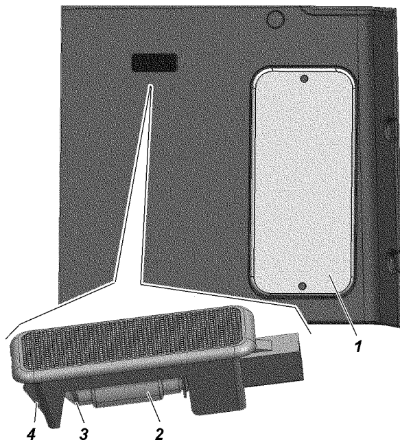
Рис. 9.53. Плафон освещения багажника: 1 -крышка; 2 -лампа; 3 - держатель лампы; 4 - фиксаторы
